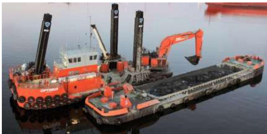
Figur 34, Enskopeverk som lastar en bogserad pråm.
