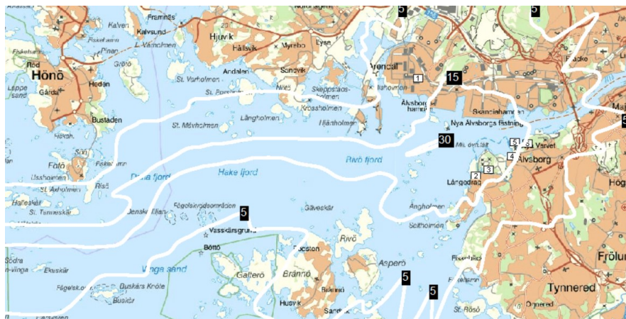
Figur 19 Haltbidraget från muddring i farleden, översta årsmedelvärde, mitten 98-percentil dygnsvärde och längst ner 98-percentil timmesvärde.
