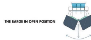
Figur 14. T.v. typisk jackup-rigg, t.h. schematisk bild över botten tömmande pråm.
