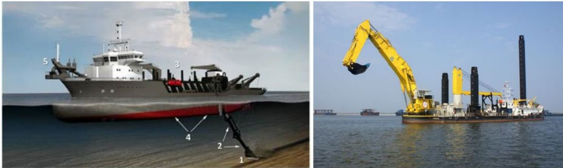
Figur 13. Exempel på sugmudderverk t.v. och enskopeverk t.h.
