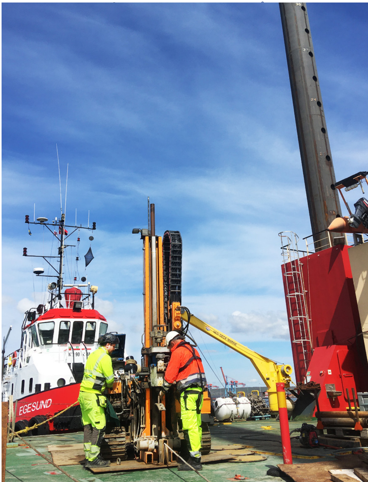
Jack-up rigg som används för geoteknisk undersökning. Undersökningen ingår i kommande miljökonsekvensbeskrivning för Skandiaporten. Fotograf: Patrik Benrick
