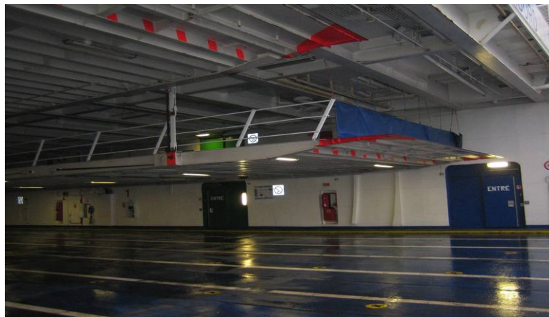
Bild 9. Skyddsanordning vid akterkant av hängdäck.
