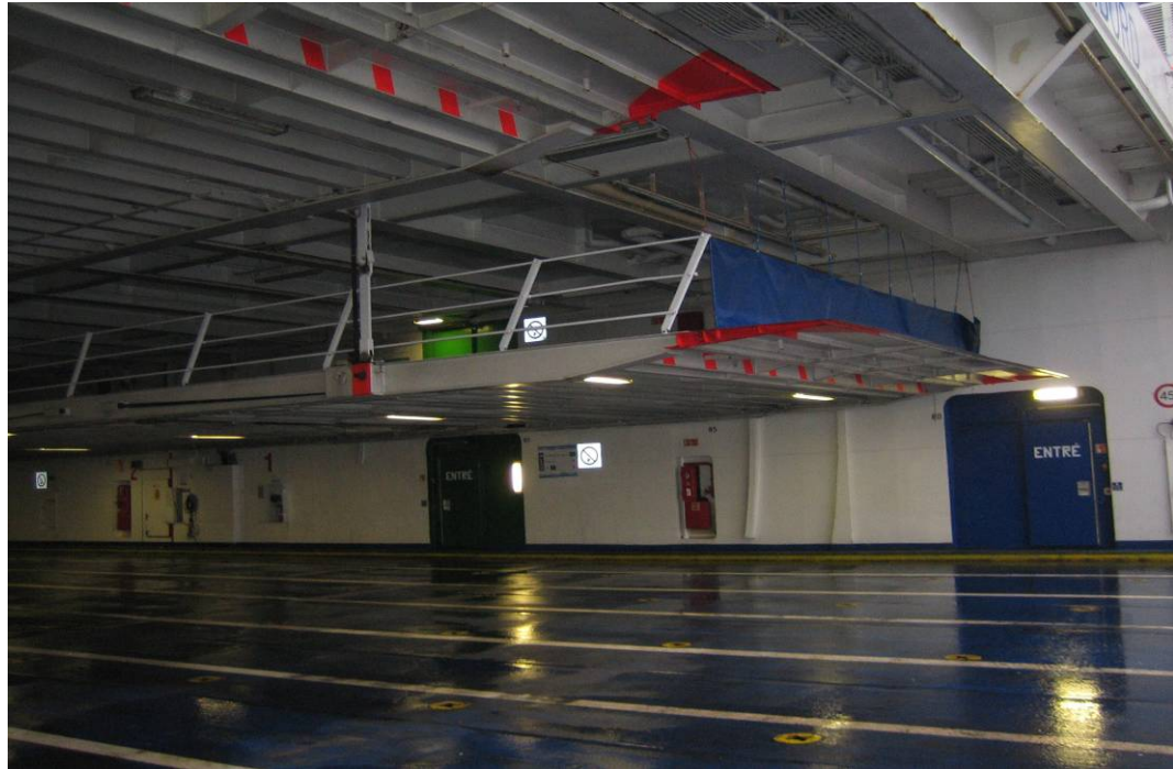
Bild 5. De aktra hängdäckens aktra ände som firas ner till däck 5
