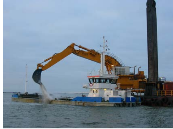
Figur 9. Exempel på enskopeverk. Foto: Göteborgs Hamn AB.
