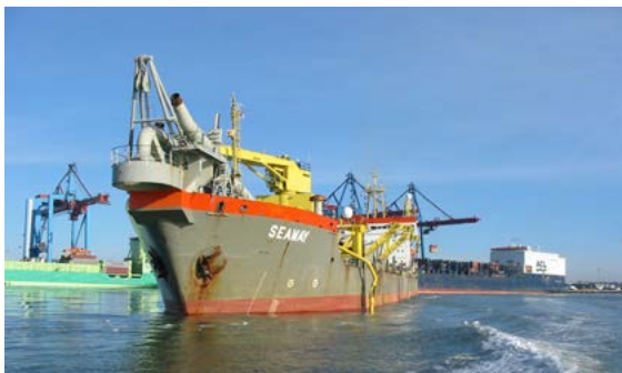
Figur 8. Exempel på sugmudderverk. Foto: Göteborgs Hamn AB.
