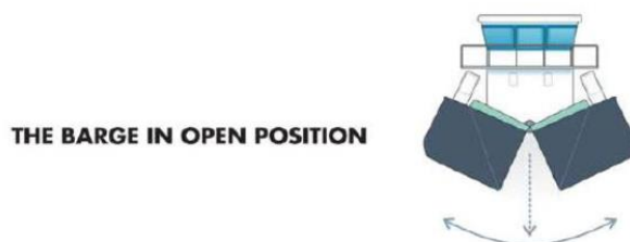
Figur 8 Bottentömmande pråm, s.k. split barge. Källa Boskalis (boskalis.se).
