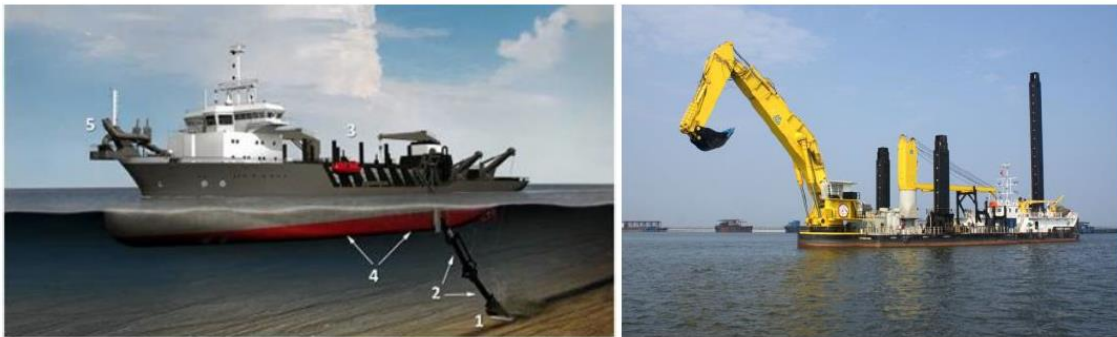
Figur 7 Exempel på sugmudderverk t.v. och enskopeverk t.h.
