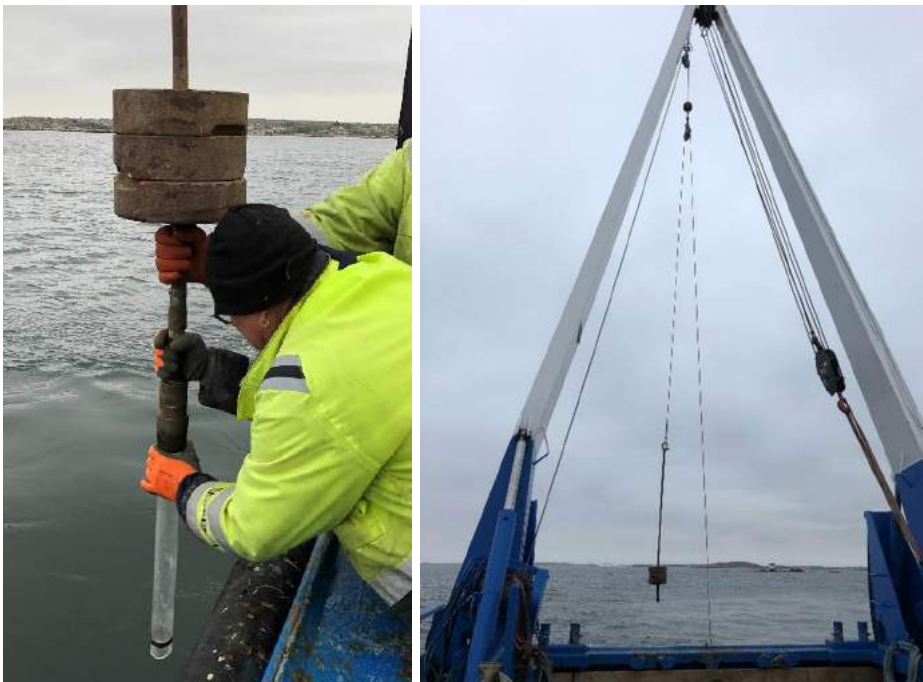
Figur 5 Den vänstra bilden visar hur rörprovtagaren på Saxkran laddas för provtagning i Steg 1. Den högra bilden visar provtagaren i kranen på Saxkran.
