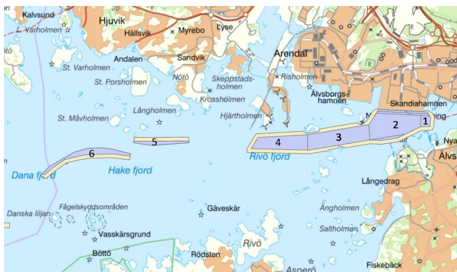
Figur 1 – Arbetszoner utanför Skandiahamnen där muddring av sten och botten sediment och anläggning av kantfyrar skall utföras under dagtid och kvällstid. Område 1 och 2 och i viss mån 5 ligger närmast bostäder. Under kvällar och helger är riktvärdena för buller sänkta, se tabell 2 och 3.
