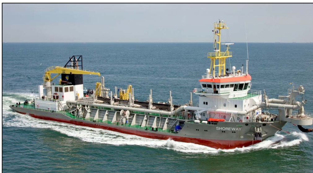
Figur 9. Sugmuddarfartyg, Shoreway. Kapacitet 5 600 m 3 . Foto: Boskalis.
