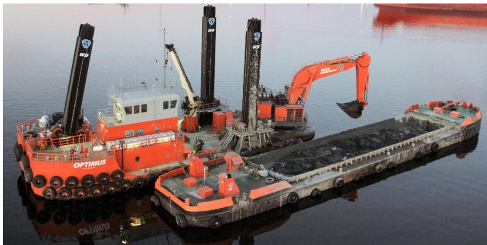
Figur 9. Enskopeverk som lastar en bogserad pråm.
