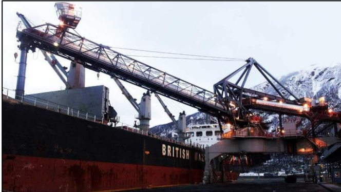
Figur 7.3.3.1 Bild på Skeppslastare i Narvik. När den stora skeppslastaren är intrimmad kommer den att kunna lasta cirka 50 000 ton järnmalsprodukter per dygn enligt uppgifter från Northland Resources. . Källa: Tekniskt PM Projekt Malmporten, Luleå Hamn, 02.7.1. Nya Kajkonstruktioner.
