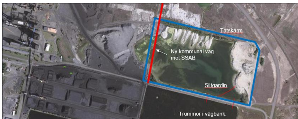
Figur 6.5.2.1 Åtgärdsplaner inför utfyllnad av den inre Skvampen. Figuren illustrerar även en tätskärm (blått) om M2-massor kommer att nyttjas för utfyllnad.
