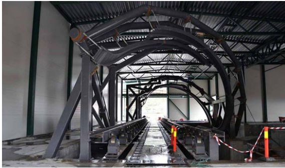
Figur 2.2.4.3 Northland Resources lossningsanläggning för sidotippade vagnar i Narvik. Elektrifierade lok kan ej köra igenom.
