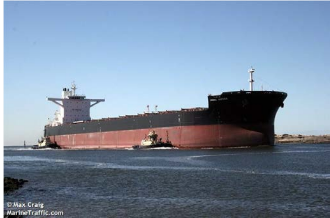
Figur 2.2.1.6 Jabal Nafusa, Bulk carrier, Capesize 169 097 d.w.t, längd 290 m, bredd 45 m
