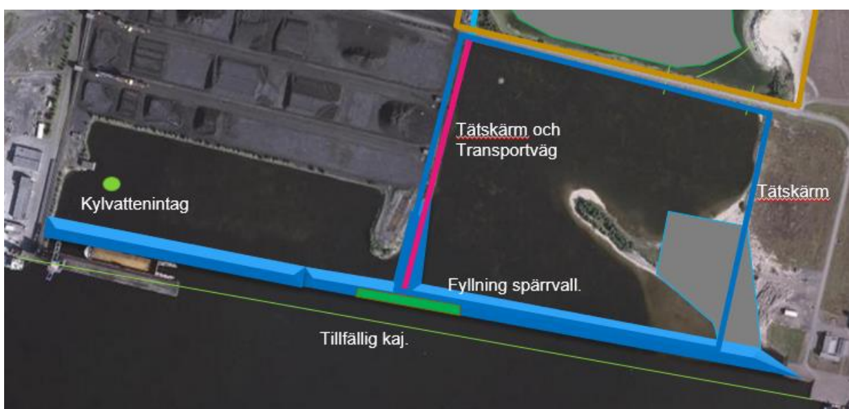
Figur 3.1.6 Steg 6, Invallning Spärrvall och tät skärm.
