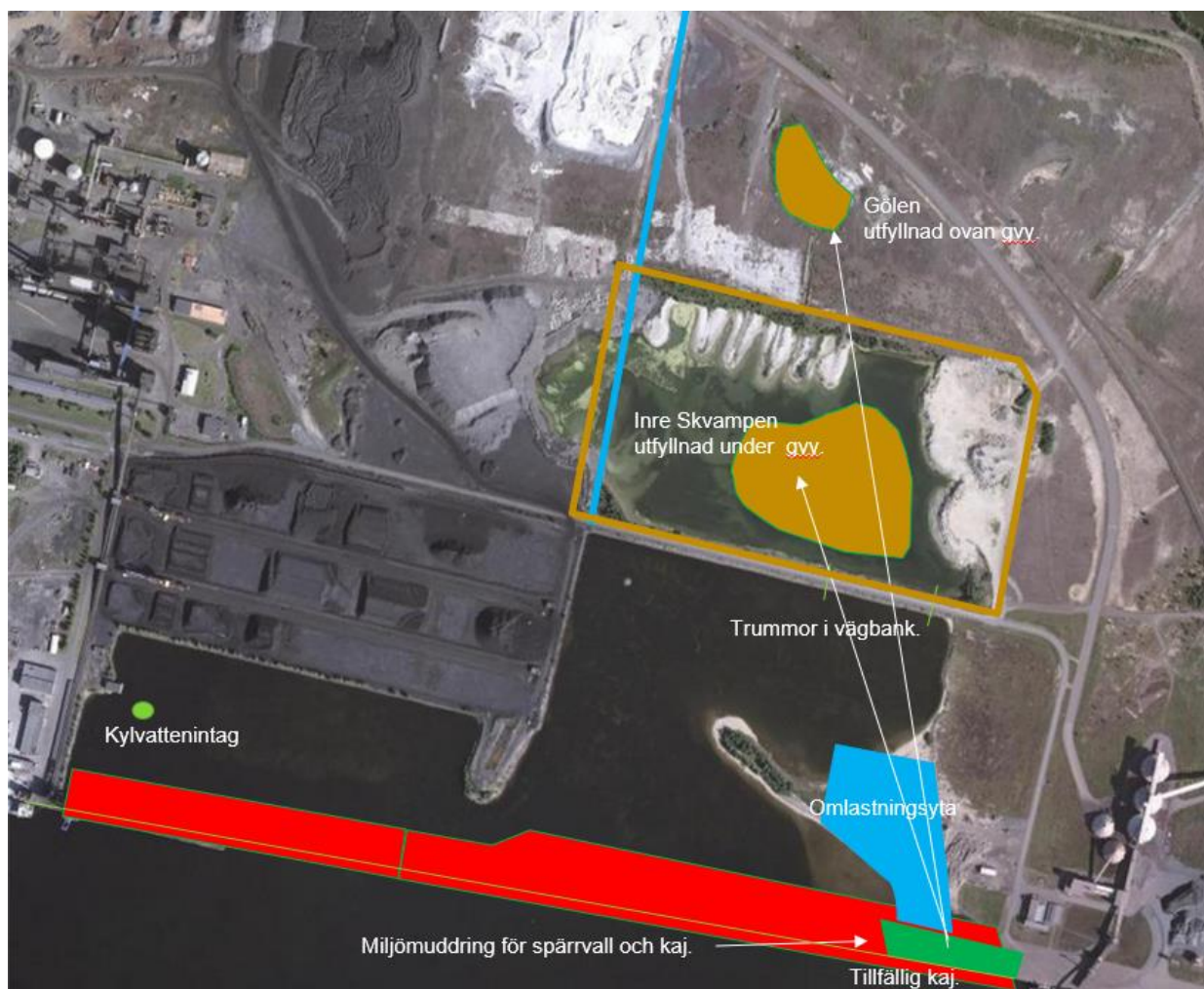
Figur 3.1.3 Steg 3, miljömuddring farled
