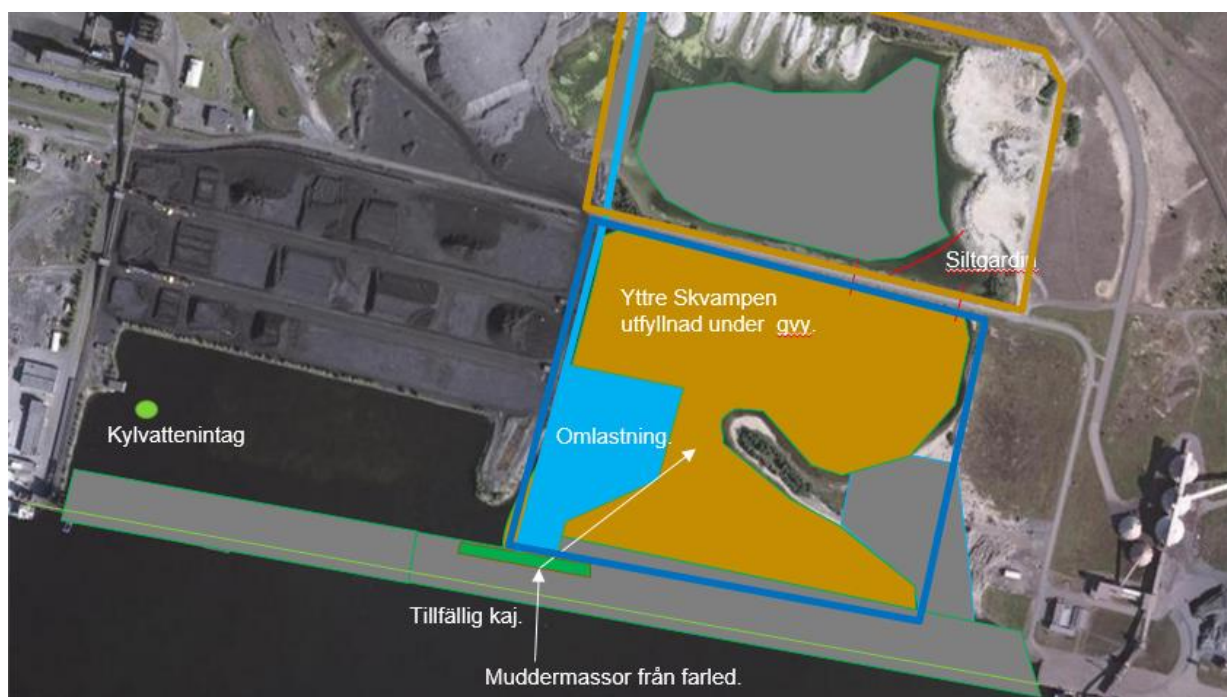
Figur 3.1.7 Steg 7, miljömuddring, M2, i farled till yttre Skvampen
