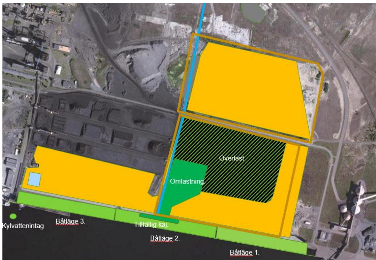
Figur 3.1.10 Steg 10, Kajbyggnation och utfyllnad för kajer.
