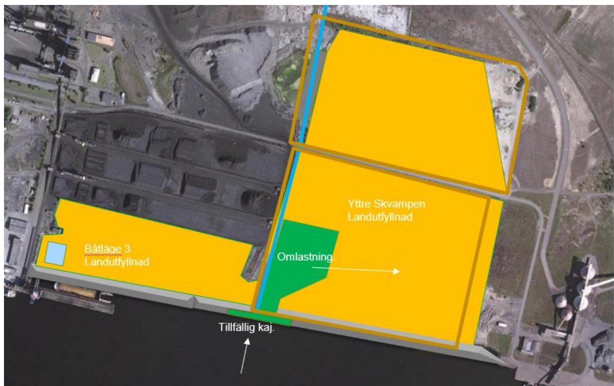
Figur 3.1.9 Steg 9, Landutfyllnad för yttre Skvampen samt båtläge 3.
