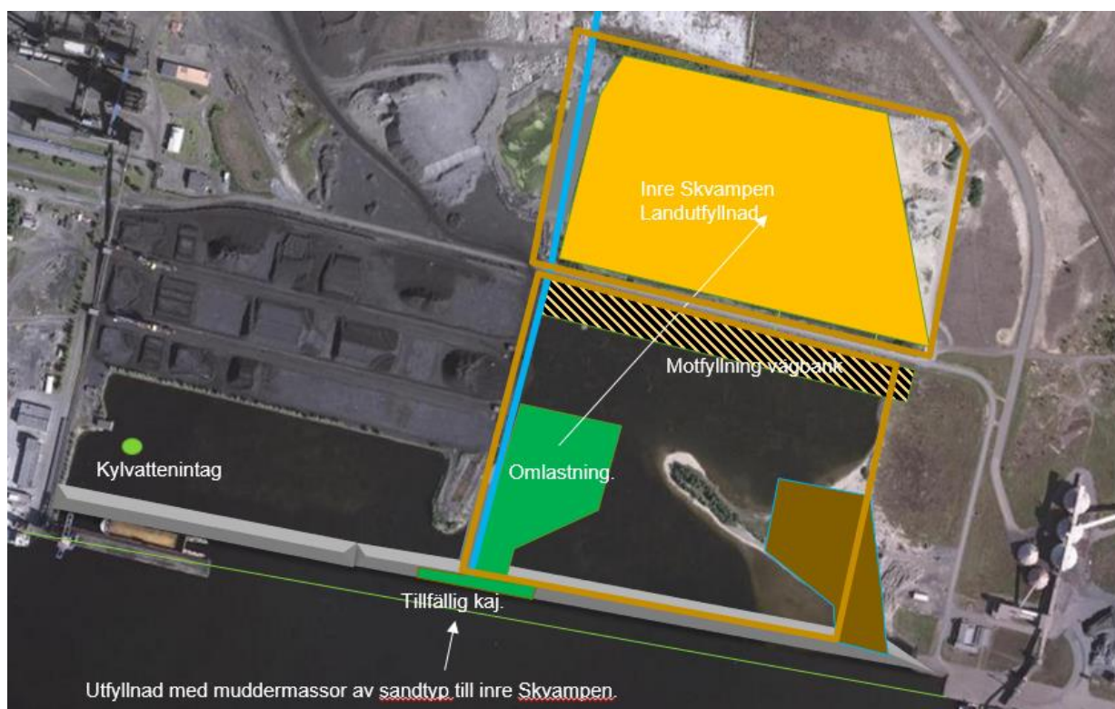
Figur 3.1.8 Steg 8, Landutfyllnad med M1 massor till den inre Skvampen.
