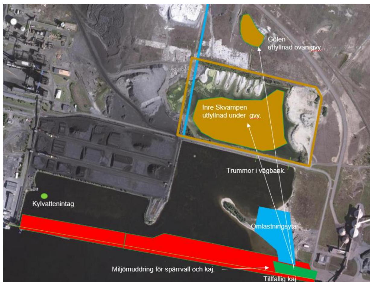
Figur 3.1.4 Steg 4, miljömuddring för spärrvall och kaj.
