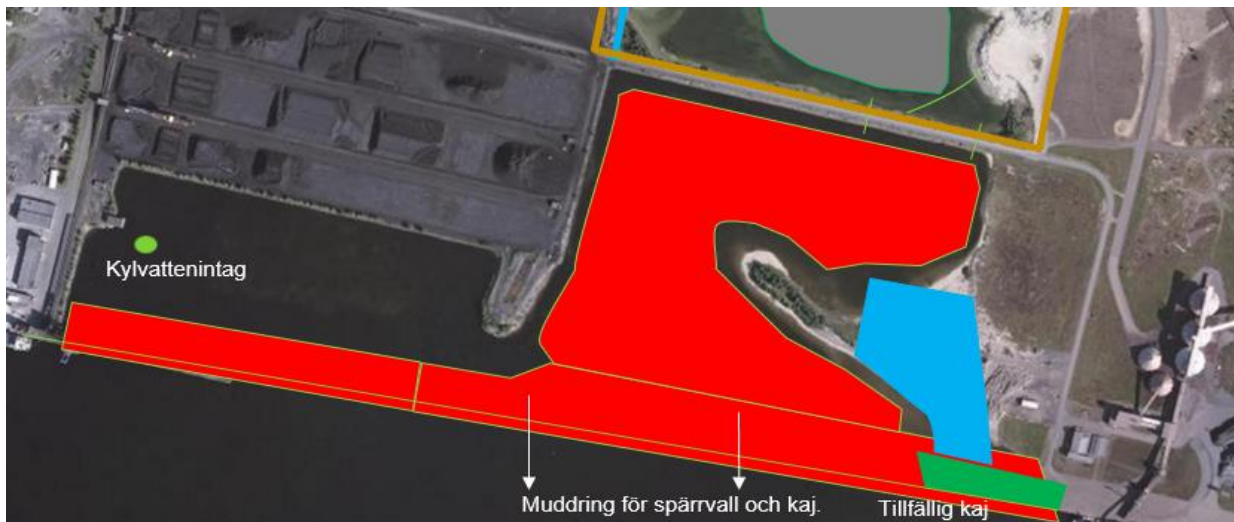
Figur 2.3 Muddring för spärrvall, kaj och landutfyllnad
