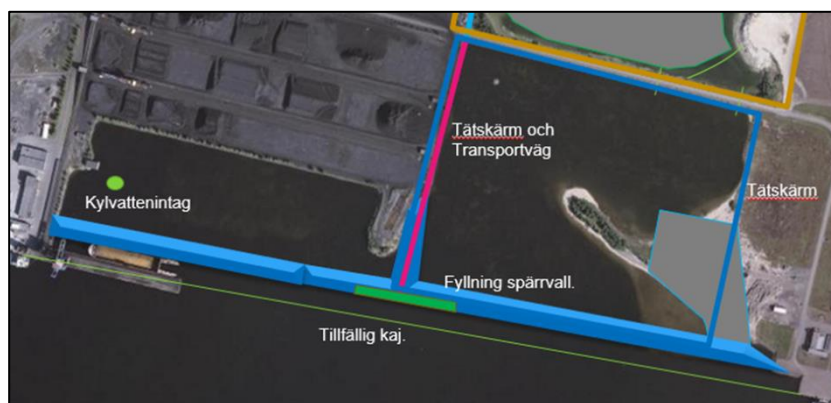
Figur 6.4.4.1 Fyllning för spärrvall illustreras av den breda blå ytan. Här påvisas även en alternativ placering av den tillfälliga kajen. Figuren illustrerar även en tätskärm om M2-massor kommer att nyttjas för utfyllnad.
