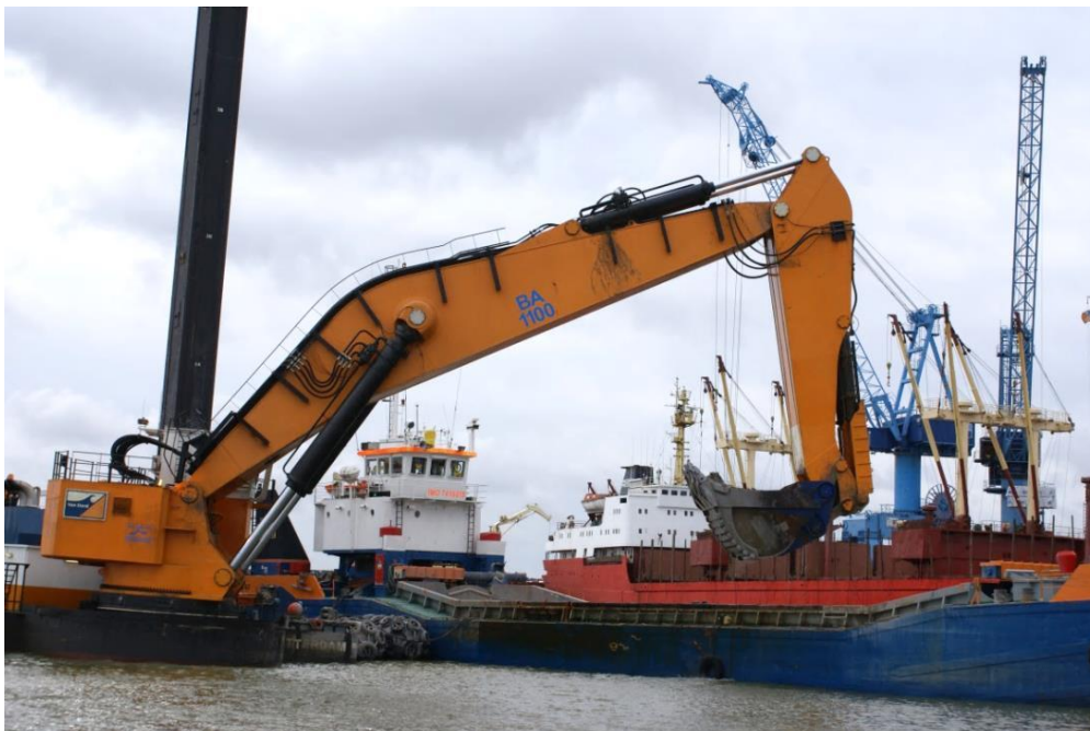
Figur 6. Exempel på muddring med skopa
