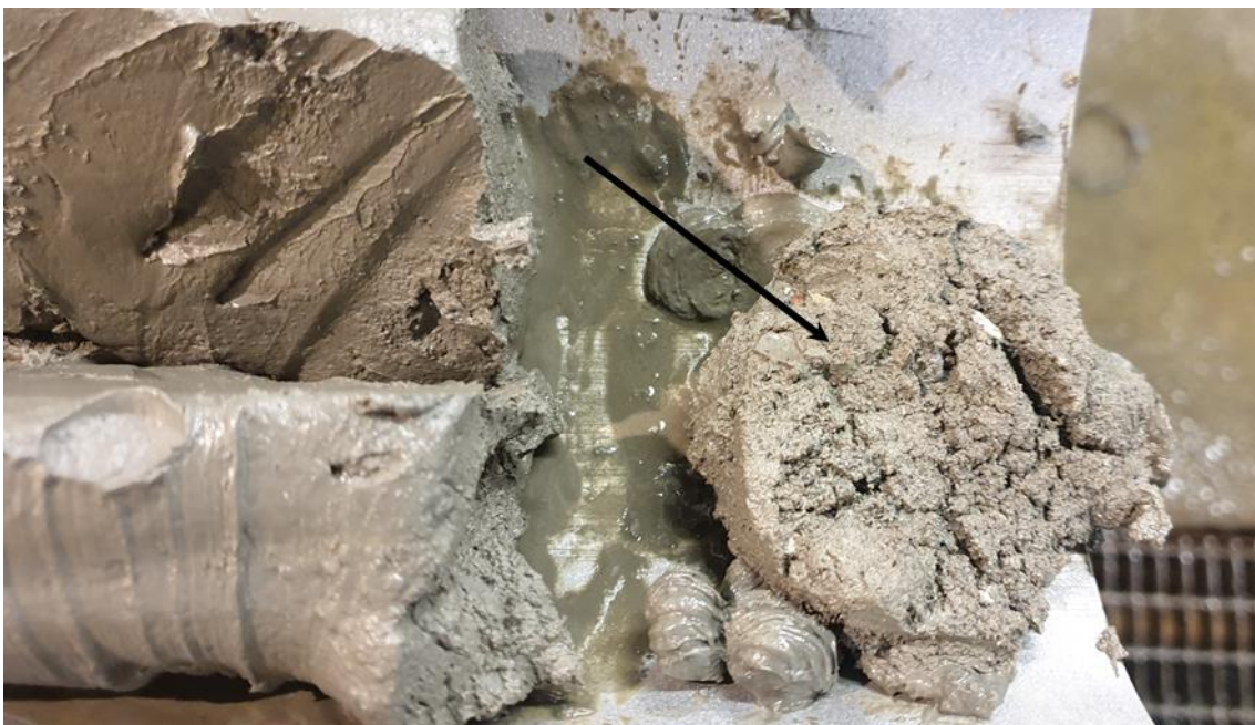
Figur 7 Övergången till sandig lera med inslag av småsten och skalrester på ca två meters sedimentdjup.
