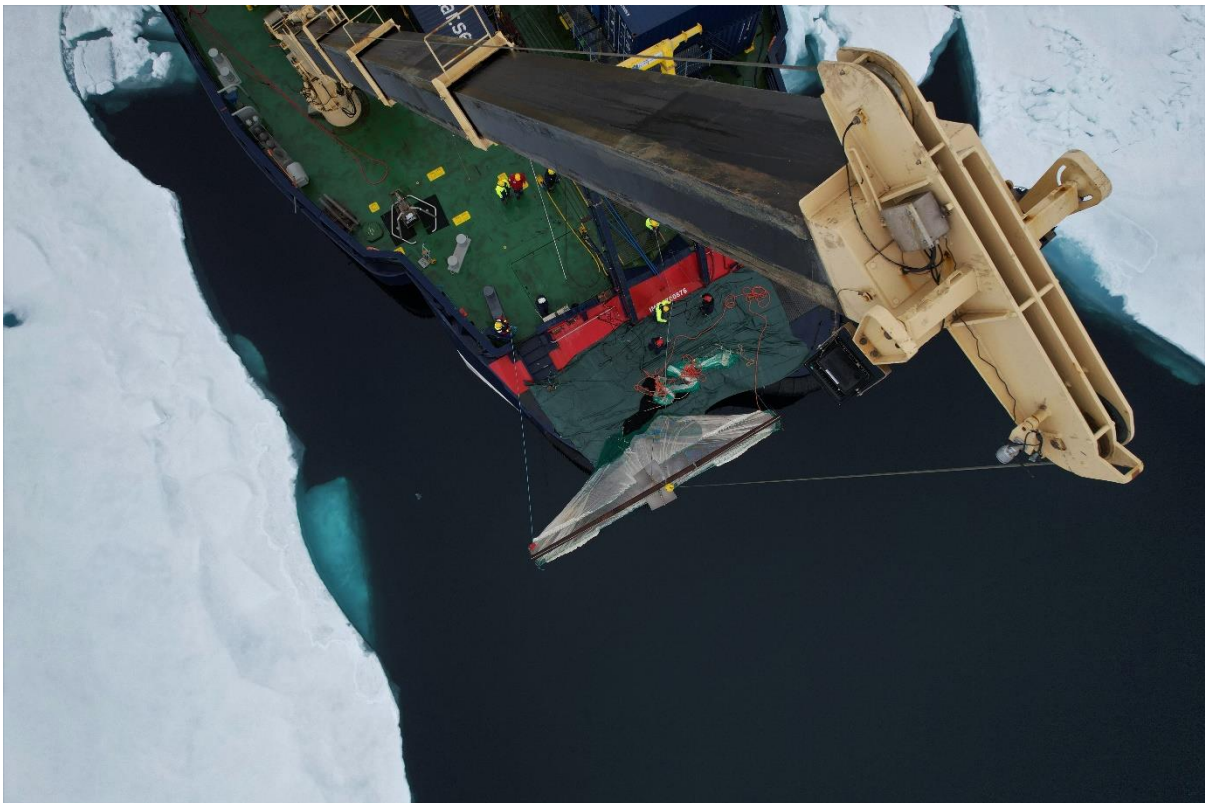
Isättning av det stora Beamer-trålen, 30 meter långt och 10 m i diameter.
