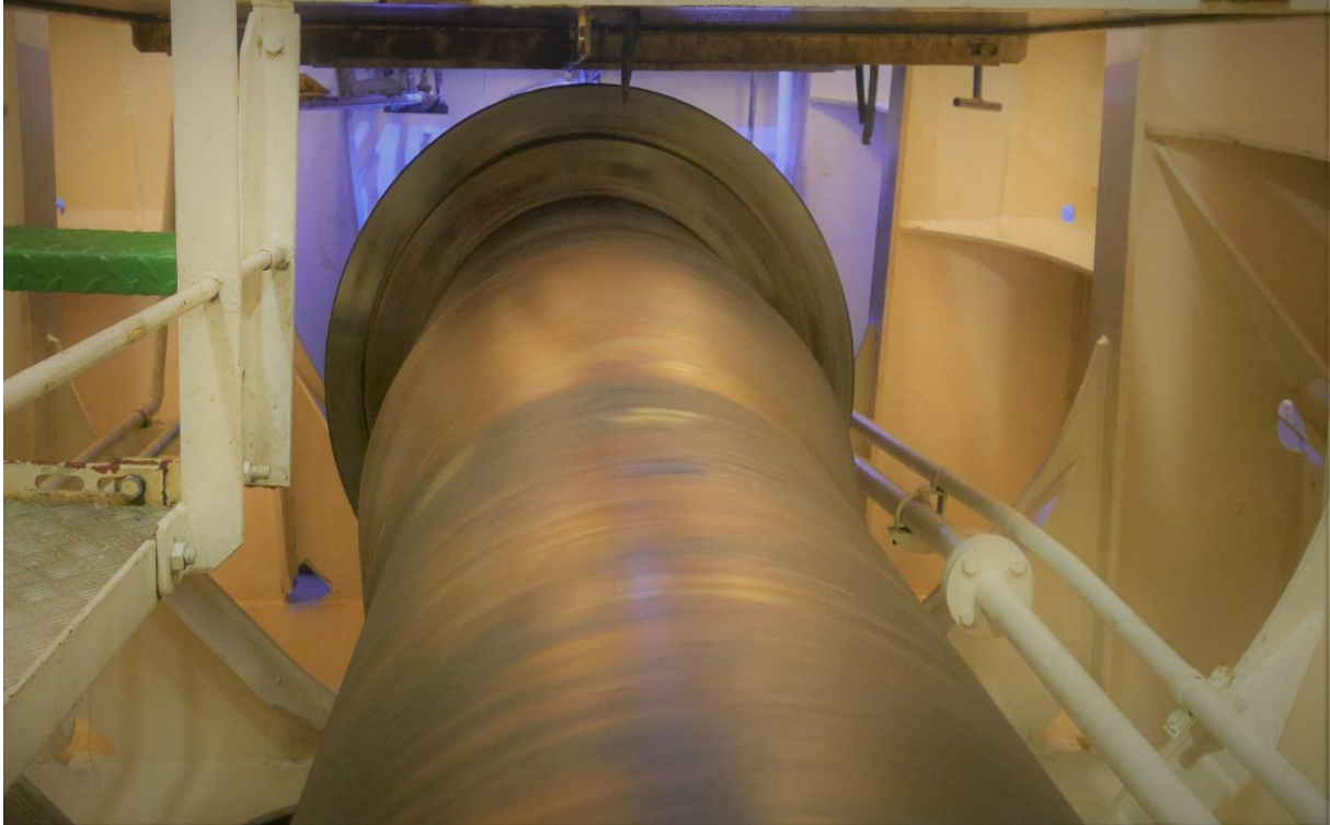
Odens snurrande propelleraxel på Bb sida
