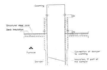
FIGURE AT FIRE DAMPERS - INSULATION ON TEST SPECIMENS AND POSITION OF UNEXPOSED FACE THEPROCOUPLES
