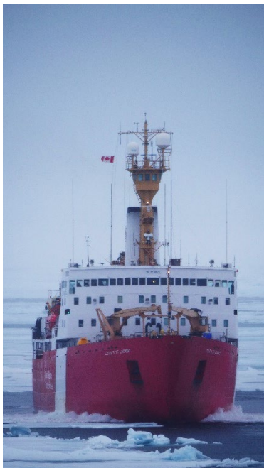
Louis S. st-Laurent, längd: 120m Bredd: 24m Djupgående: 9,91m Propellerkraft: 3 x 6714Kw Displacement: 15324ton
